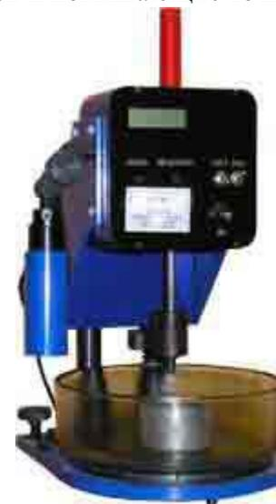
Рис. 1. Пенетрометр ПБА-1Ф полуавтоматический ГОСТ 11501-78 [3].
